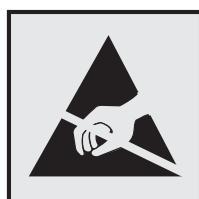
Этим знаком обозначаются компоненты, чувствительные к статическому электричеству. Перед тем, как прикасаться к поверхностям, отмеченным такими знаками, необходимо дотронуться до металлической поверхности вне области, отмеченной символом.
