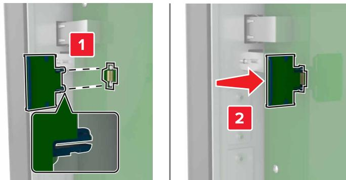
**Примечание:** Разъем платы микропрограммного обеспечения должен соприкасаться с системной платой по всей длине и располагаться в одной плоскости с ней.
