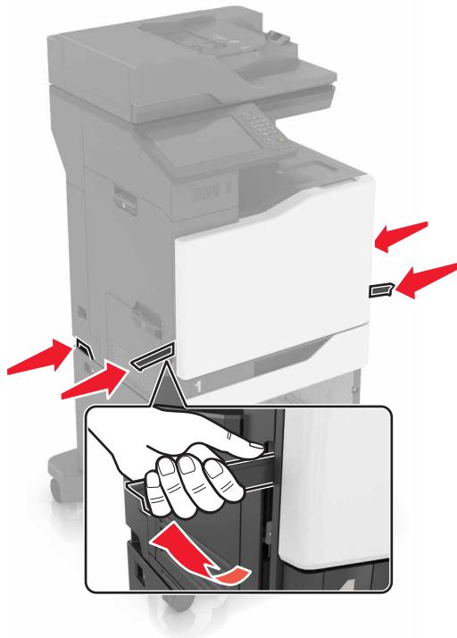
**Примечание:** Если дополнительные лотки уже установлены, открепите их от принтера перед тем, как приподнять принтер. Не пытайтесь поднимать принтер и лотки одновременно.
