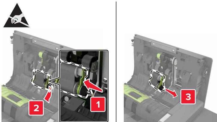
**5** Распакуйте новый ролик подачи УАПД.**6** Установите новый ролик подачи УАПД до защелкивания на месте.
