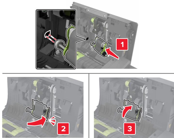
**7** Установите крышку ролика захвата УАПД до защелкивания на месте.
