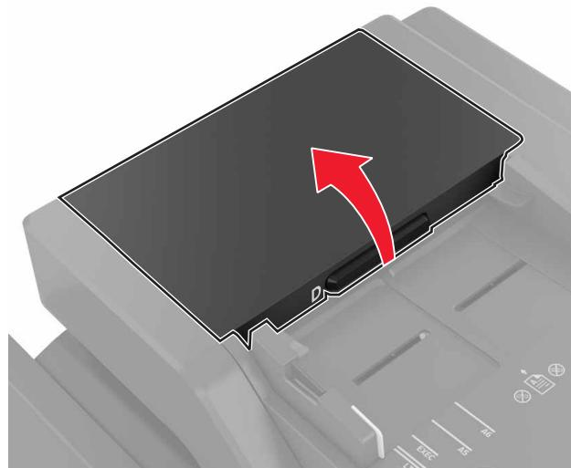
3 Снимите крышку ролика разделения УАПД.
