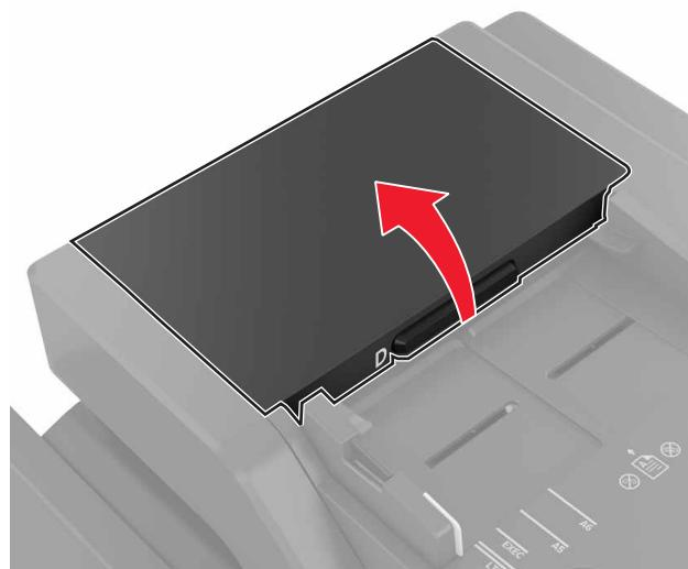
**3** Снимите крышку ролика захвата УАПД.
