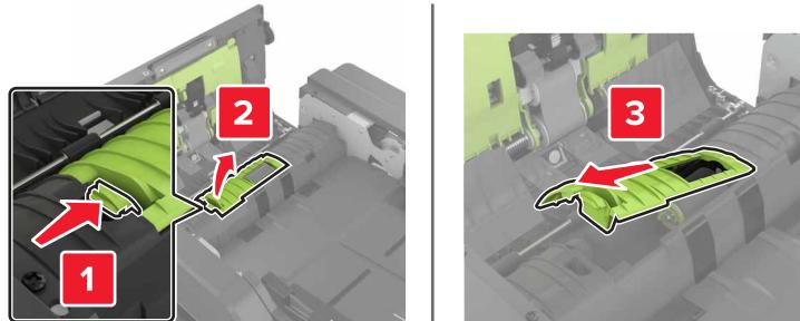
4 Снимите ролик разделения УАПД.
