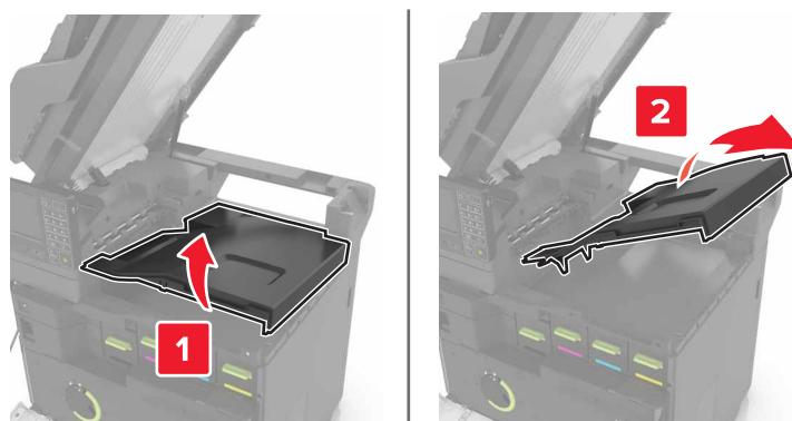
6 Снимите крышку соединителя брошюровщика со скрепками.
