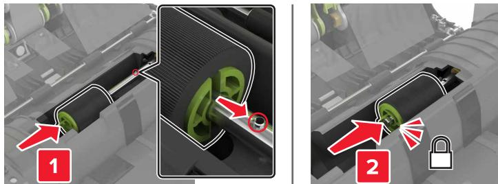
7 Установите крышку ролика разделения УАПД до защелкивания на месте.
