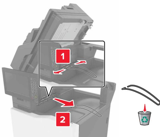
4 Снимите крышки области перемещения бумаги и соединителя брошюровщика со скрепками.
