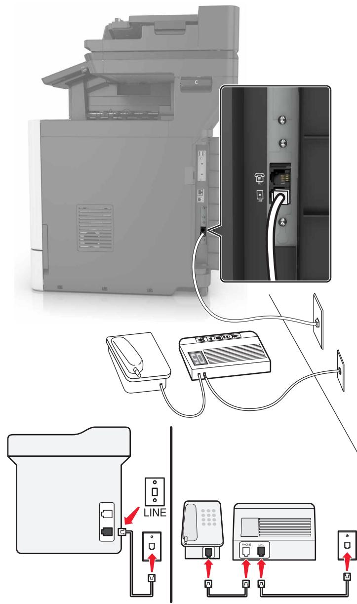
**1** Подсоедините один конец телефонного кабеля к линейному порту принтера.
