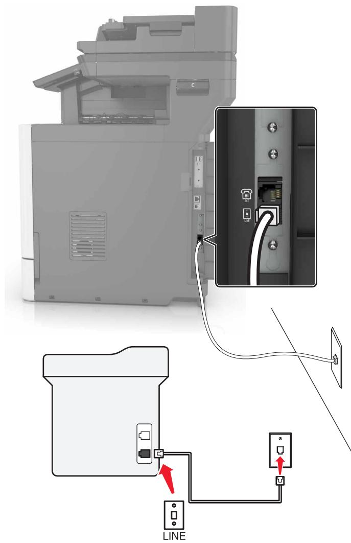
**1** Подсоедините один конец телефонного кабеля к линейному порту принтера.
