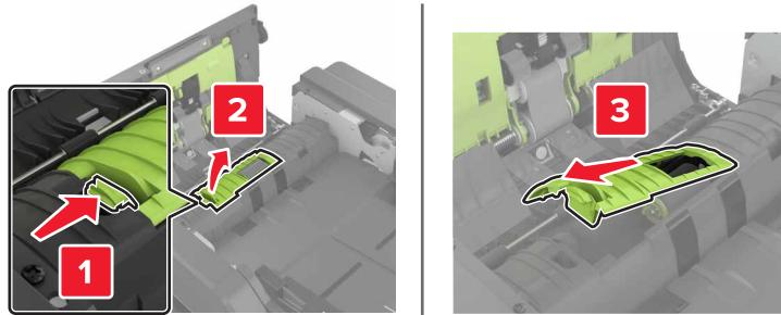
4 Снимите ролик разделения УАПД.
