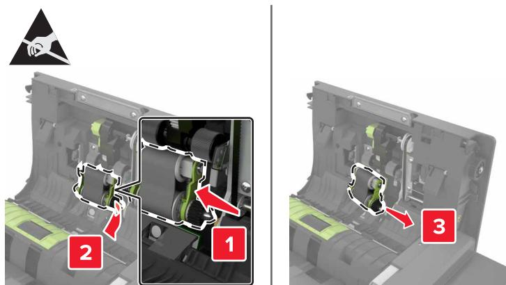
**5** Распакуйте новый ролик подачи УАПД.**6** Установите новый ролик подачи УАПД до защелкивания на месте.
