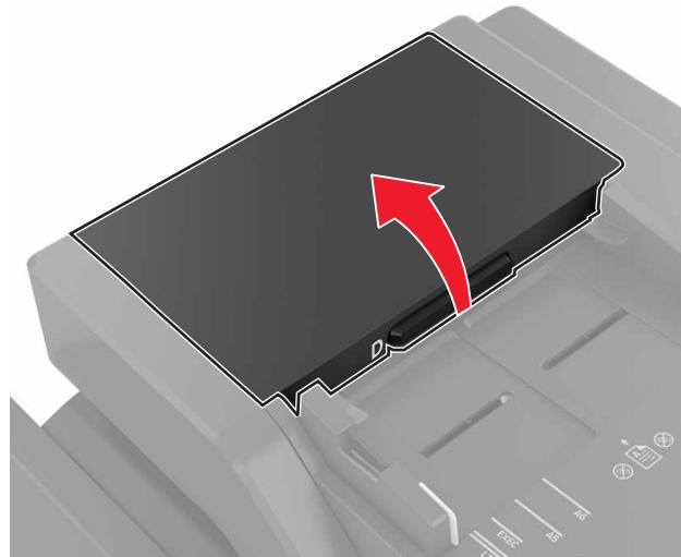
3 Снимите крышку ролика разделения УАПД.
