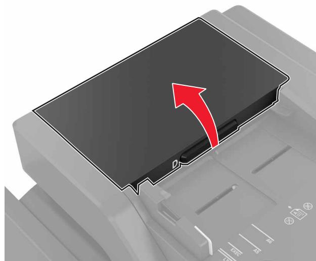
**3** Снимите крышку ролика захвата УАПД.
