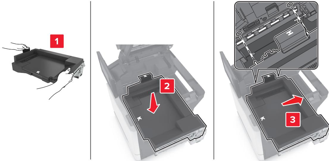
10 С усилием нажмите на модуль транспортировки бумаги до защелкивания на месте.
