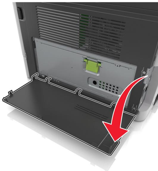
2 Öffnen Sie die Schutzabdeckung der Steuerungsplatine mithilfe des grünen Griffs.
