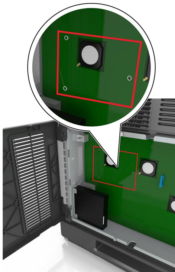
**Примечание:** Если установлен дополнительный порт ISP, то жесткий диск принтера необходимо установить в порт ISP.
