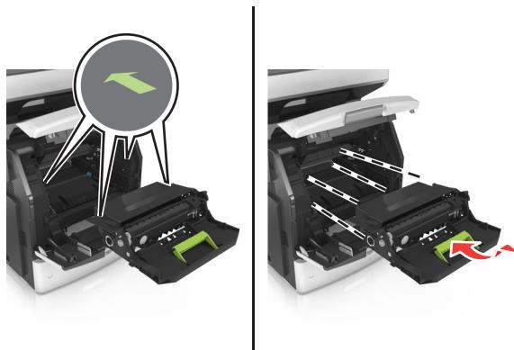
7 Установите картридж с тонером, совместив стрелки на боковых направляющих картриджа со стрелками на боковых направляющих внутри принтера, а потом вставьте картридж в принтер.
