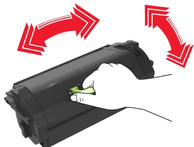
**4** Установите картридж с тонером, совместив стрелки на боковых направляющих картриджа со стрелками на боковых направляющих внутри принтера, а потом вставьте картридж в принтер.
