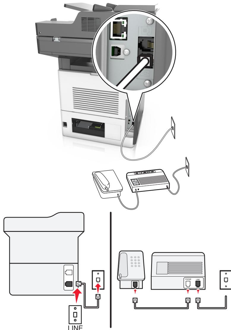
**1** Подсоедините один конец телефонного кабеля к линейному порту принтера.
