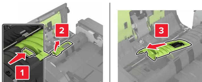
4 Снимите ролик разделения УАПД.
