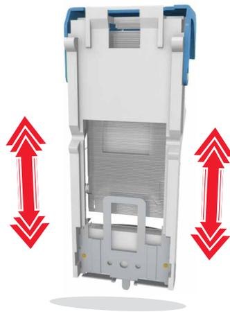
**7** Drücken Sie die Heftklammerkassette fest in den Finisher, bis die Heftklammerkassette *einrastet*.
