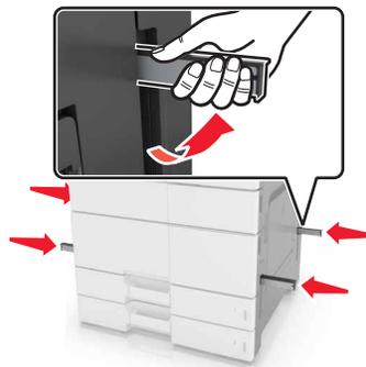
**7** Richten Sie den Drucker am Fach aus, und setzen Sie den Drucker auf das Fach.
