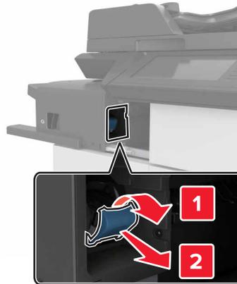
**4** Heben Sie den Heftklammerschutz mit Hilfe der Metalltasche hoch, und entfernen Sie anschließend alle losen Heftklammern.
