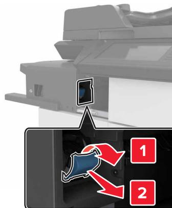
**3** Entfernen Sie die leere Heftklammerkassette aus dem Heftklammerhalter.
