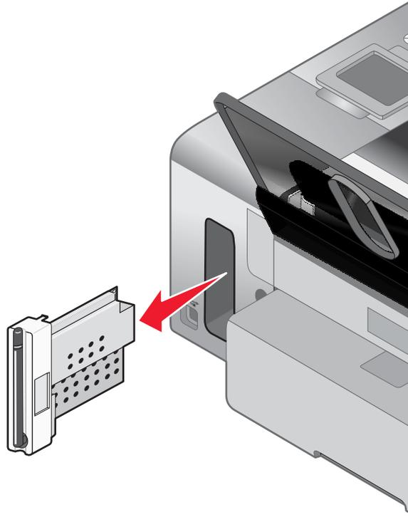
**3** Vuelva a instalar el servidor de impresión interno.
