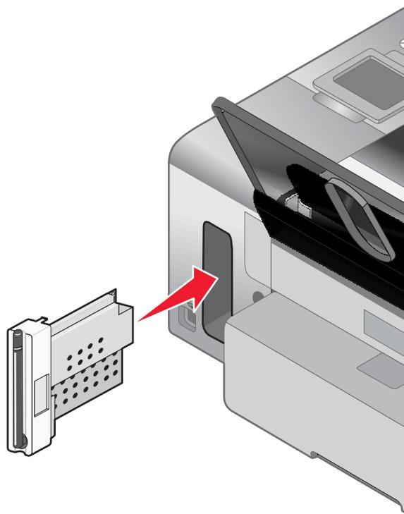
**Advertencia:** Los servidores de impresión inalámbrica son especialmente sensibles a la electricidad estática. Toque un material metálico, como la estructura de la impresora, antes de tocar el servidor de impresión inalámbrica.
