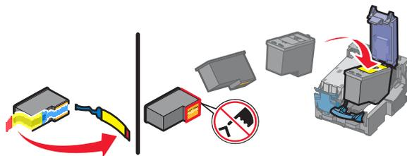
**Advertencia:** No toque el área de contacto dorada de la parte trasera ni los inyectores metálicos de la parte inferior del cartucho.
