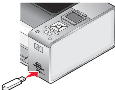
**Remarque :** un adaptateur peut être nécessaire si le lecteur flash ne s'insère pas directement dans le port.
