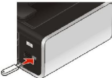
**Remarque :** un adaptateur peut être nécessaire si le lecteur flash ne s'insère pas directement dans le port.
