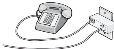
Jika perangkat telekomunikasi Anda menggunakan saluran telepon tipe Amerika Serikat (RJ11), ikuti langkah-langkah berikut untuk menghubungkan perangkat:
