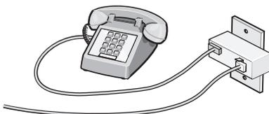
2 Schließen Sie die Telekommunikationsgeräte direkt am EXT-Anschluss an der Rückseite des Druckers an.
