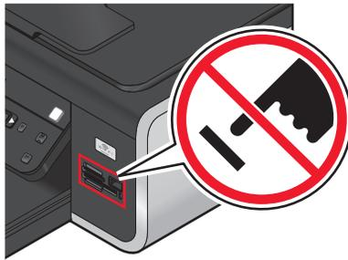
**Hinweis:** Der Drucker erkennt jeweils nur ein aktives Mediengerät. Wenn Sie mehrere Mediengeräte einsetzen, wird auf dem Display eine Meldung mit der Aufforderung angezeigt, das vom Drucker zu erkennende Gerät anzugeben.
