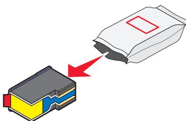
**17** Se for incluída uma unidade de armazenamento, remova o cartucho de tinta colorida da unidade de armazenamento.
