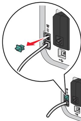
**4** Conecte um segundo fio telefônico do modem do computador à porta EXT ☎ da impressora.
