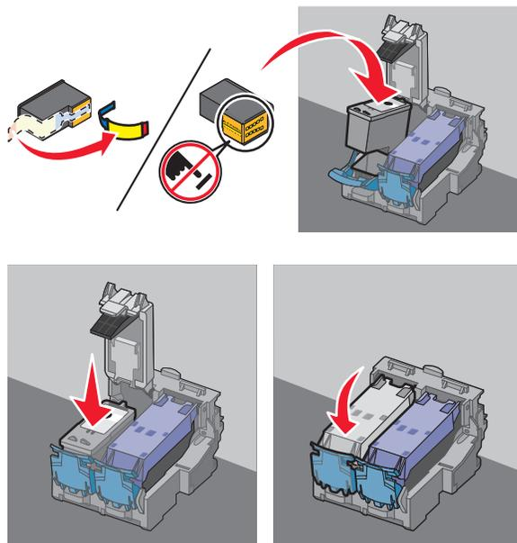
**Aviso—Dano Potencial:** *não* toque na área de contato dourada na parte posterior nem nos orifícios de metal na parte inferior do cartucho.
