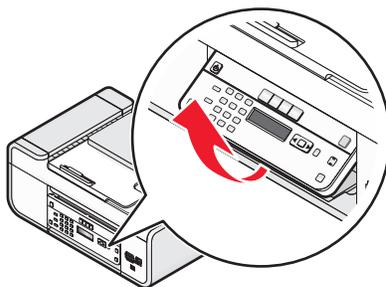
**4** Se for necessário instalar um revestimento adesivo do seu idioma, retire a parte de trás dos revestimentos para expor o adesivo.
