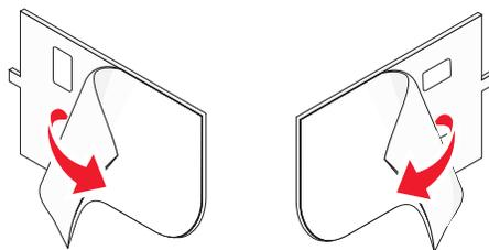
**5** Coloque os revestimentos adesivos nas áreas de encaixe do painel de controle da impressora e depois pressione os adesivos para baixo.
