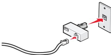
**Nota:** esse é o adaptador do Reino Unido. O seu adaptador pode parecer diferente, mas ele encaixará na tomada de telefone usada na sua região.
