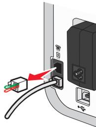
**Nota:** quando esse plugue é removido, qualquer equipamento de uma região ou país específico que for conectado à impressora usando o adaptador (como ilustrado) não funcionará adequadamente.
