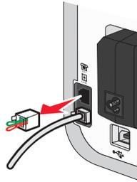
**Nota:** quando esse plugue é removido, qualquer equipamento de uma região ou país específico que for conectado à impressora usando o adaptador (como ilustrado) não funcionará adequadamente.
