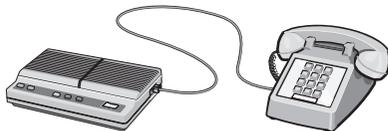
5 Hubungkan kabel telepon ketiga dari mesin penjawab ke port EXT
