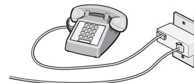
若您的電信設備使用美式 (RJ11) 電話線，請遵循以下步驟來連接該設備：
