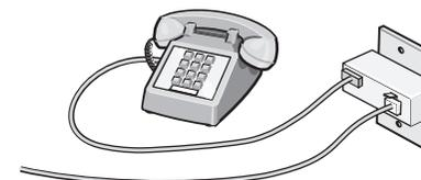
2 將您的電信設備直接連接到印表機背面的 EXT（電話分機）連接埠。
