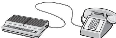
5 Conecte un tercer cable telefónico del contestador automático al puerto EXT
