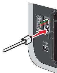
**3** Ligue a outra extremidade do cabo de telefone à ranhura N de uma tomada activada da rede telefónica.
