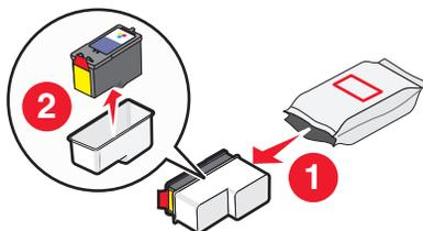
**20** Remova a fita do tinteiro de cores, insira o tinteiro no suporte direito e, em seguida, feche a tampa do suporte do tinteiro de cores.
