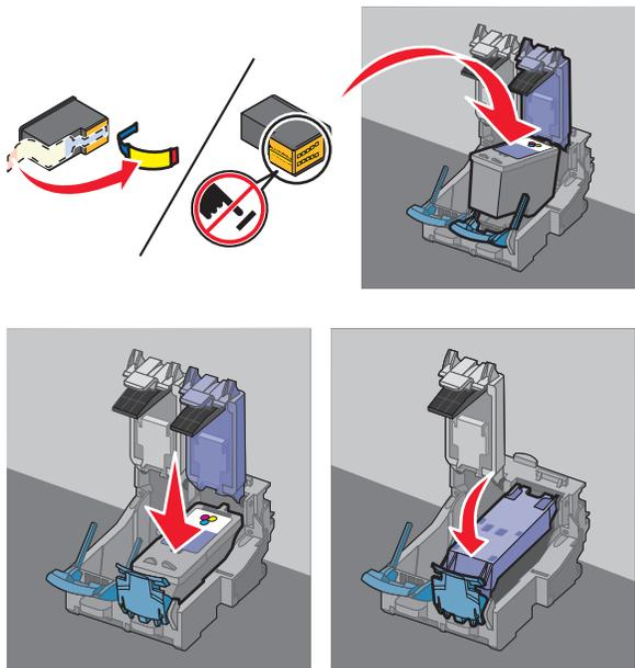
**21** Se for fornecido um tinteiro de preto na caixa, abra a embalagem metálica do tinteiro de preto e, em seguida, retire o tinteiro da embalagem.
