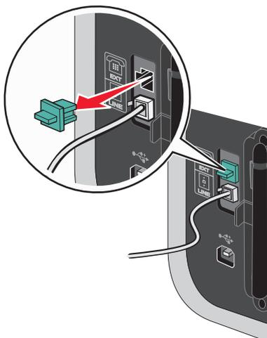
**4** Ligue um segundo cabo de telefone entre o modem do computador e a porta EXT ☎ da impressora.
