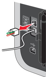
**Nota:** Depois de removida esta ficha, o equipamento específico de região ou do país que for ligado à impressora através do adaptador, conforme mostrado, não funcionará correctamente.
