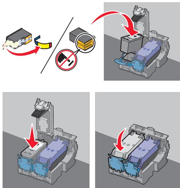
**Aviso: Danos potenciais:** Não toque na área dos contactos dourados na parte posterior nem nos ejectores de metal na parte inferior do tinteiro.
