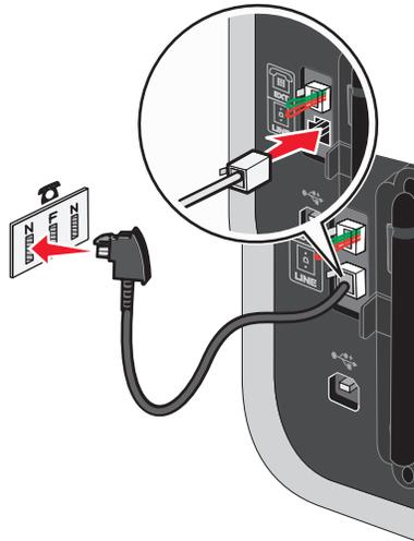
**4** Se pretender utilizar a mesma linha para comunicações por fax e telefone, ligue uma segunda linha telefónica (não fornecida) entre o telefone e a ranhura F de uma tomada activada da rede telefónica.
