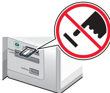
**Hinweis:** Der Drucker erkennt jeweils nur ein aktives Mediengerät. Wenn Sie mehrere Mediengeräte einsetzen, wird auf dem Display eine Meldung mit der Aufforderung angezeigt, das vom Drucker zu erkennende Gerät anzugeben.
