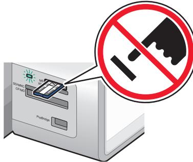
Wenn der Drucker die Speicherkarte erkennt, wird die Meldung **Speicherkarte erk.** auf dem Bedienfelddisplay angezeigt.
