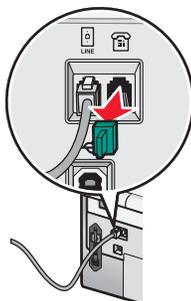
**4** Verbinden Sie das Telefon und den Anrufbeantworter mit einem zweiten Telefonkabel.
