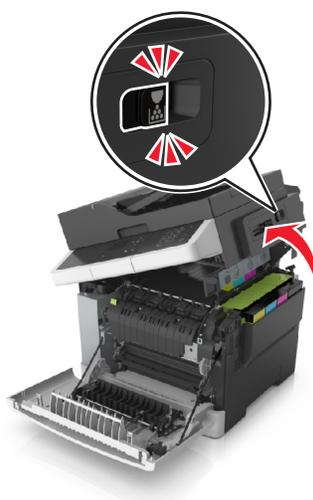
3 Tire de la palanca verde para abrir la cubierta del fusor.
