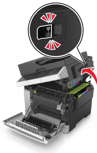
3 Extraiga el cartucho de tóner levantando las palancas y, a continuación, tirando suavemente del kit de imagen.
