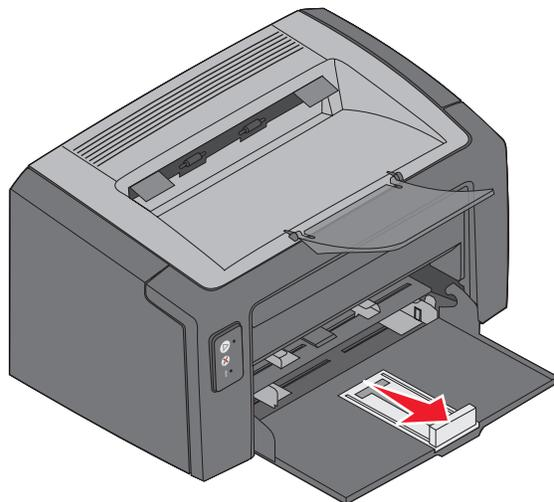
**請注意：**若要縮小寬度，推左導引夾。若要增加寬度，壓下右導引夾所附的定位拉片，將它向右滑動。
