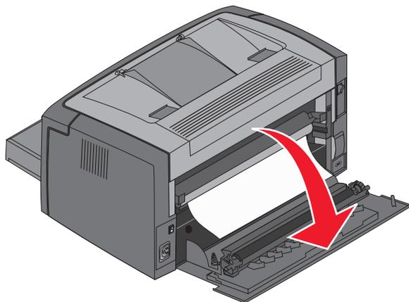
**警告：**當後門開啓時，小心不要碰觸連接的滾輪。碰觸滾輪可能會造成污染，而影響列印品質。不要長時間開啓後門，曝光會損毀長效型感光鼓套件的藍色感光鼓，而影響列印品質。
