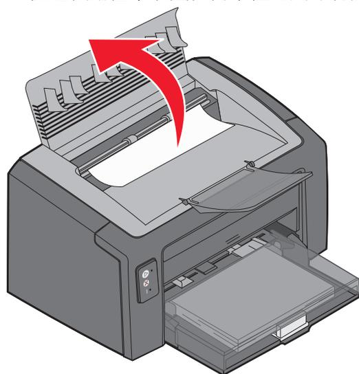
**請當心：**加熱熔合組件的溫度可能很高。爲了避免個人傷害，請小心打開上層門蓋從加熱熔合組件區取出夾紙。
