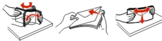
**Hinweis:** Durch das Auffächern wird verhindert, dass die Kanten der Briefumschläge zusammenkleben. Dadurch werden sie ordnungsgemäß eingezogen. Die Briefumschläge dürfen nicht geknickt oder geknittert werden.
