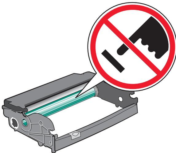
**6** Setzen Sie die neue Druckkassette in das Fotoleiter-Kit ein, indem Sie die Rollen der Druckkassette auf die Schienen des Fotoleiter-Kits ausrichten. Schieben Sie die Druckkassette so ein, dass sie *hörbar* einrastet.
