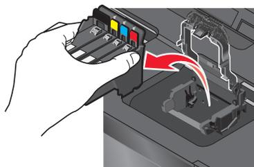
3 Nettoyez les contacts de la tête d'impression à l'aide d'un chiffon propre et sans peluches.
