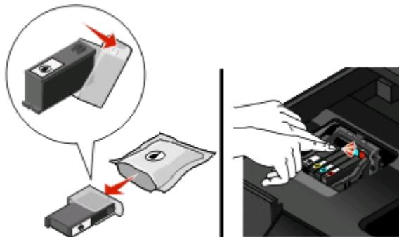
**Hinweis:** Setzen Sie die neuen Tintenpatronen direkt nach dem Entfernen der Schutzkappe ein, damit keine Luft in die Patrone gelangt.
