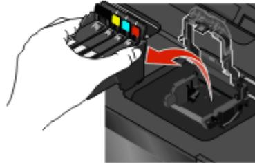
3 Reinigen Sie die Kontakte am Druckkopf mit einem sauberen, fusselfreien Tuch.
