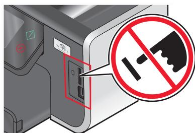
**Advertencia—Posibles daños:** No manipule ningún cable, adaptador de red, conector, dispositivo de memoria ni la impresora en las zonas que se muestran mientras esté imprimiendo, leyendo o escribiendo en la tarjeta de memoria. Se produce una pérdida de datos.
