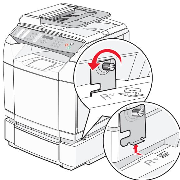
6 Lösen Sie die linke Rändelschraube und entfernen Sie die linke Halterung.
