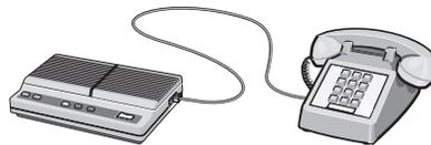
**5** Verbinden Sie das dritte Telefonkabel zuerst mit dem Anrufbeantworter und dann mit dem EXT-Anschluss
