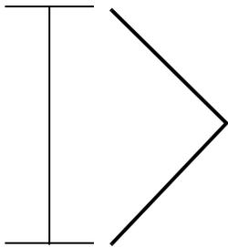
Der Abstand zwischen den beiden Markierungen gibt beispielsweise einen Wiederholungsfehler an, der alle 34,6 mm (1,4 Zoll) auftritt. Dies deutet darauf hin, dass die Fotoleitereinheit unter Umständen ausgetauscht werden muss.
