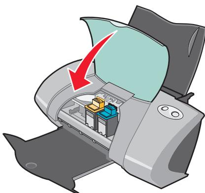
**Remarque :** Le capot avant doit être refermé pour que vous puissiez lancer une nouvelle d'impression.
