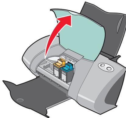
Si l'imprimante n'est pas en train d'imprimer, le chariot des cartouches se place en position de chargement.
