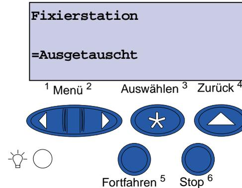
8 Drücken Sie **Auswählen**, um den Zähler der Fixierstation auf Null zurückzusetzen.
