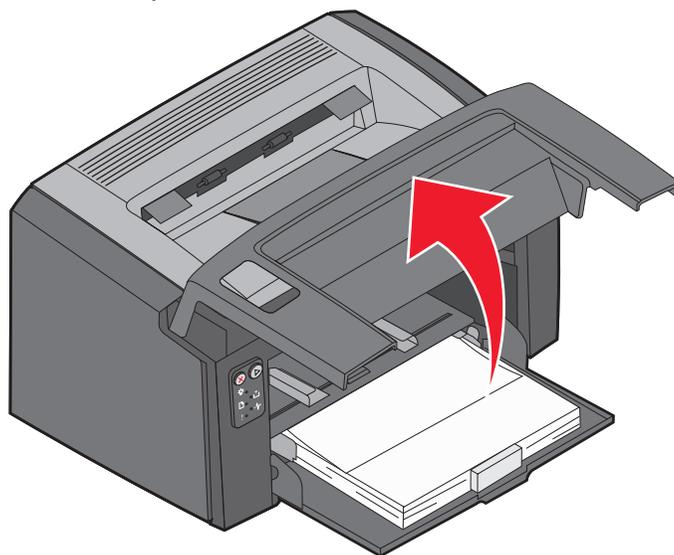
**Примечание.** Для доступа к материалу, замятому в зоне за картриджем с тонером, может потребоваться извлечь картридж с тонером; извлеченный картридж с тонером следует поместить на чистую ровную поверхность. После обнаружения и извлечения замятого материала установите картридж с тонером на место.
