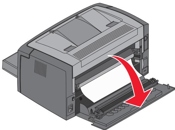
**Предупреждение.** При открытой задней дверце соблюдайте осторожность во избежание прикосновения к закрепленному на ней валлику. Прикосновение к валлику может привести к его загрязнению и снижению качества печати. Не оставляйте заднюю дверцу открытой в течение длительного времени. Воздействие света может повредить синий фотобарабан, входящий в комплект фотобарабана с длительным сроком службы, и снизить качество печати.
