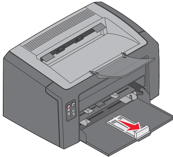
**Nota:** para disminuir la anchura, empuje la guía izquierda. Para aumentar la anchura, presione la lengüeta de la guía derecha y desplácela hacia la derecha.
