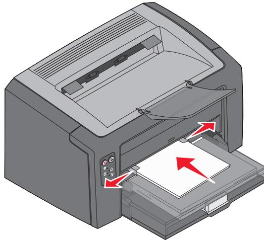
**Nota:** no fuerce el material de impresión para introducirlo en el alimentador. Forzar el material de impresión provoca atascos.
