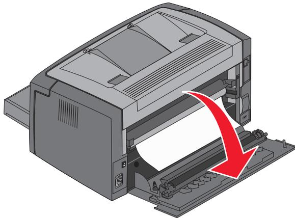
**Advertencia:** tenga cuidado de no tocar el rodillo instalado cuando la puerta posterior esté abierta. Si se toca el rodillo, éste se puede contaminar y la calidad de impresión se verá afectada. No deje la puerta posterior abierta durante un período de tiempo prolongado. La exposición a la luz daña el tambor azul del kit de fotoconductor de larga duración y afecta a la calidad de impresión.
