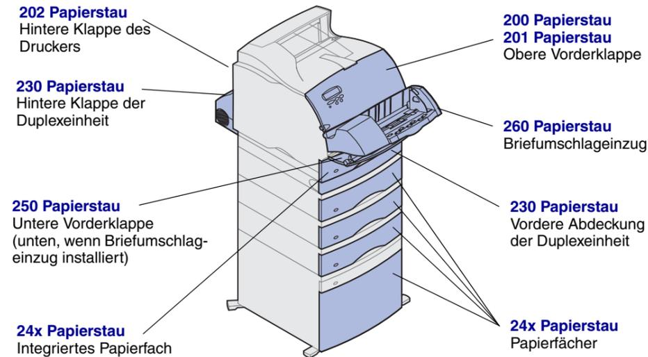
**Warnung:** Versuchen Sie nicht, Papierstaus mit Hilfe von Werkzeugen zu beseitigen. Hierdurch kann der Drucker dauerhaft beschädigt werden.
