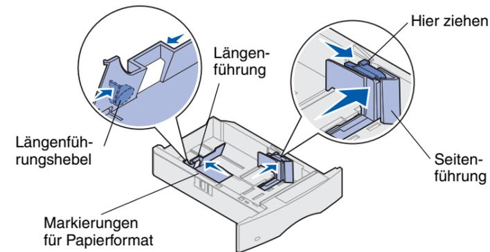
Befolgen Sie diese Anweisungen, um Druckmedien in eines der Standard- oder der optionalen Papierfächer einzulegen. Das Papier wird in alle Papierfächer auf die gleiche Weise eingelegt.
