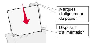
Exercez une pression sur la languette d'ouverture et le guide papier pour les rapprocher et faites glisser le guide papier vers le bord du papier.
