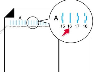
Par exemple, dans le groupe d'alignement A, 16 est le numéro de la page de test imprimée la plus proche d'une ligne droite.
