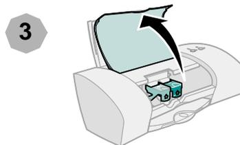
**Hinweis:** Wenn Sie die vordere Abdeckung öffnen, wird der Druckschlitten in die Ladeposition gebracht.
