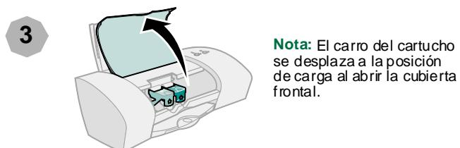
**Nota:** El carro del cartucho se desplaza a la posición de carga al abrir la cubierta frontal.
