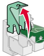
**b** Setzen Sie die Druckkassette in den Wagen ein.
