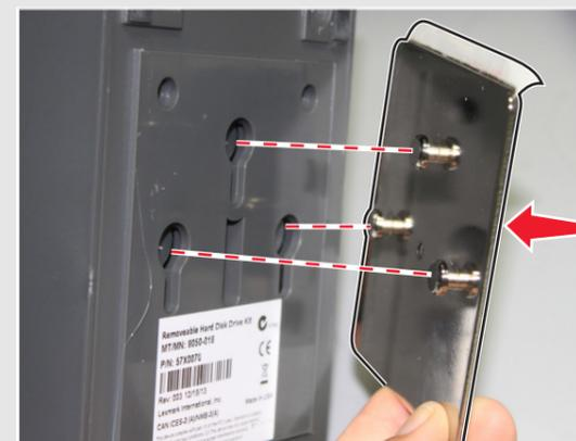
2 Deslice la placa hasta que oiga un *clic* que indica que se ha fijado.
