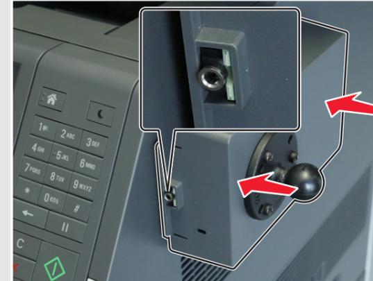
6 Faites glisser le boîtier de commande hors de la plaque. Appuyez sur la plaque pour la fixer correctement, puis placez à nouveau le boîtier de commande sur la plaque.
