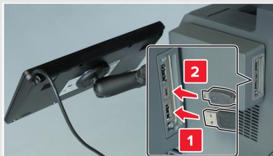
8 Installez les passe-câble sur l'imprimante, puis faites-y passer le câble USB.
