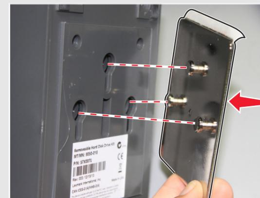
2 Deslize a placa até obter confirmação de que está posicionada através de um clique.
