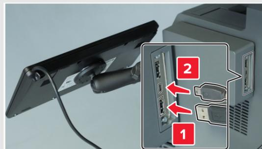
8 Fixe os grampos do encaminhamento da cablagem à impressora e, de seguida, passe o cabo USB através destes.
