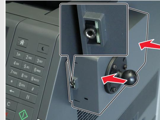
6 Deslize a caixa de controlo para a remover da placa. Pressione a placa para obter uma adesão adequada e, de seguida, deslize a caixa de controlo de novo para a fixar à placa.
