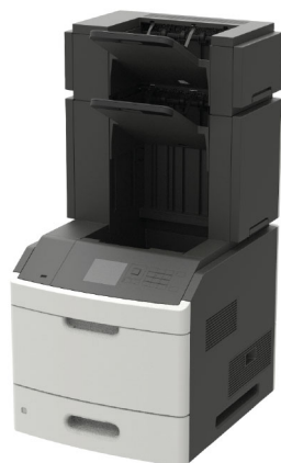
Μέγιστη διαμόρφωση προέκτασης εξόδου χαρτιού μεγάλης χωρητικό- τητας
