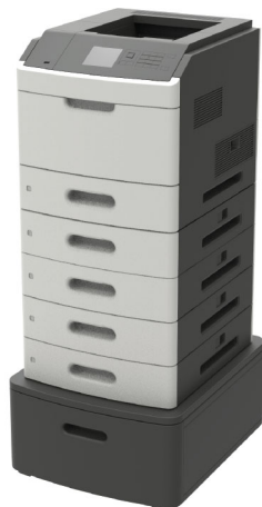
Μέγιστη διαμόρφωση προέκτασης εξόδου χαρτιού μεγάλης χωρητικό- τητας
