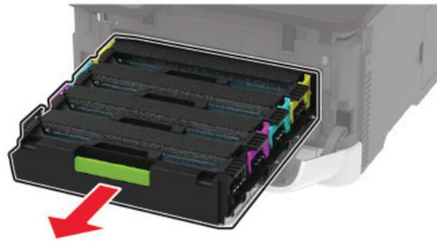
**5** Para evitar a contaminação do cartucho, coloque uma folha de papel na parte superior da bandeja do cartucho de impressão e depois insira a bandeja.
