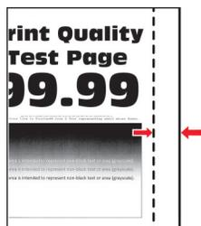
**Nota:** Antes de solucionar o problema, imprima as páginas de teste de qualidade de impressão. No painel de controle, navegue até **Configurações > Solução de problemas > Páginas de teste de qualidade de impressão**. Para modelos de impressora que não sejam de tela sensível ao toque, pressione **OK** para navegar pelas configurações.
