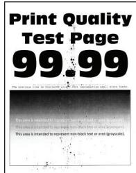
**Poznámka:** Skôr než sa pustíte do riešenia tohto problému, vytlačte strany testu kvality. V ovládacom paneli prejdite na **Nastavenia > Riešenie problémov > Tlačiť strany testu kvality**. V prípade modelov tlačiarí bez dotykové obrazovky môžete prechádzať cez nastavenia stlačením tlačidla **OK**.
