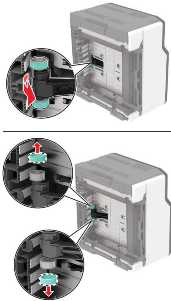
**11** Naneste izopropylalkohol na mäkkú handričku, z ktorej sa neuvoľňujú vlákna, a potom ňou utrite vyzdvihovacie kolieska.
