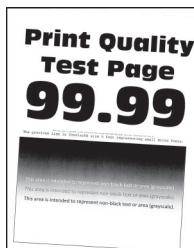
**Poznámka:** Než sa pustíte do riešenia tohto problému, vytlačte strany testu kvality. Na ovládacom paneli prejdite na položky **Nastavenia > Riešenie problémov > Tlačiť strany testu kvality**. V prípade modelov
