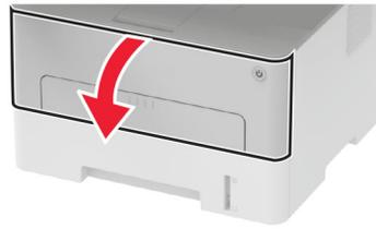
2 Entfernen Sie die gebrauchte Belichtungseinheit.
