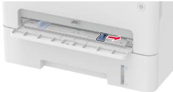
**3** Încărcați o coală de hârtie cu fața de imprimat orientată în sus.
