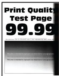
**Remarque :** Avant de résoudre le problème, imprimez les pages de test de qualité d'impression. A partir du panneau de commande, accédez à **Paramètres > Dépannage > Pages de test de qualité d'impression**. Pour
