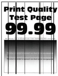
**Remarque :** Avant de résoudre le problème, imprimez les pages de test de qualité d'impression. A partir du panneau de commande, accédez à **Paramètres > Dépannage > Pages de test de qualité d'impression**. Pour les modèles d'imprimante sans écran tactile, appuyez sur
