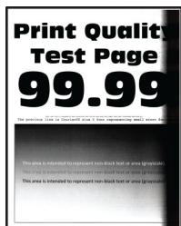
**Notă:** Înainte de soluționarea problemei, imprimăți paginile de testare a calității imprimării. Din panoul de control, accesați **Setări > Depanare > Pagini de testare a calității imprimării**. Pentru modelele de imprimantă care nu dispun de ecran tactil, apăsați **OK** pentru a naviga printre setări.
