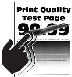
**Notă:** Înainte de soluționarea problemei, imprimăți paginile de testare a calității imprimării. Din panoul de control accesați **Setări > Depanare > Pagini de testare a calității imprimării**. Pentru modelele de imprimantă care nu dispun de ecran tactil, apăsați **OK** pentru a naviga printre setări.
