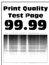
**Nota:** Antes de solucionar o problema, imprima as páginas de teste de qualidade de impressão. No painel de controle, navegue até **Configurações > Solucionar problemas > Imprimir as páginas de teste de qualidade**. Para modelos de impressora que não sejam de tela sensível ao toque, pressione **OK** para navegar pelas configurações.
