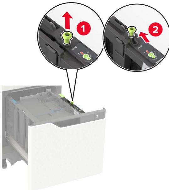
**b** 如果 A5 长度导片仍然连接，请移除它。如果导片没有连接，请继续执行[第 30 页上的第 d 步](#)。
