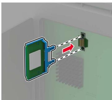
**注意：**卡上的整个连接器必须完全接触控制器板，并平整地挨着控制器板。
