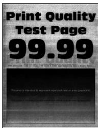
**注意：**在解决问题之前，请打印“打印质量测试页”。从控制面板，导览至**设置 > 疑难解答 > 打印质量测试页**。对于非触摸屏的打印机型号，请按
