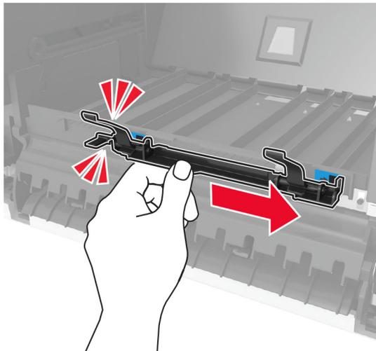
**5** 移除打印机顶部盖板。
