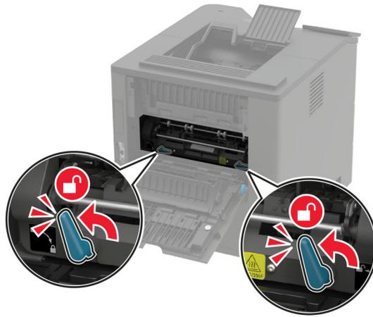
4 移除旧的加热辊定影器。
