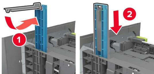
d 压住长度导片，然后将它滑动到与加载的纸张尺寸相符的正确位置上。
