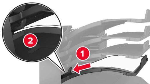
**注意：**如果纸张不在接纸架臂下面，那么会由于接纸架过满而造成卡纸。
