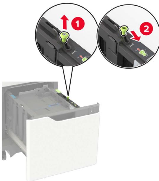
**b** 将长度导片压住并滑动到 A5 的位置，直到它发出咔嚓一声，卡入到位。
