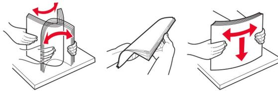
4 让可打印面朝下加载纸张，然后确认侧导片紧密地贴着纸张。
