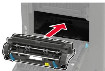
7 Fiksirajte vruću jedinicu za nanošenje tonera sa valjkom.
