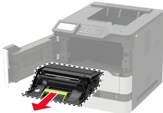
4 Otpakujte novu jedinicu za izradu slika, a zatim je protresite da biste rasporedili toner.
