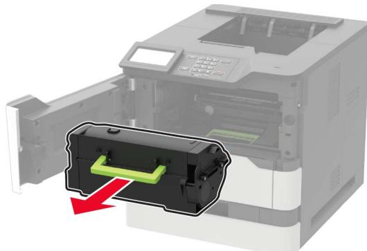
3 Uklonite jedinicu za izradu slika.
