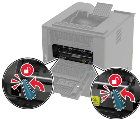
4 Uklonite iskorišćenu vruću jedinicu za nanošenje tonera sa valjkom.
