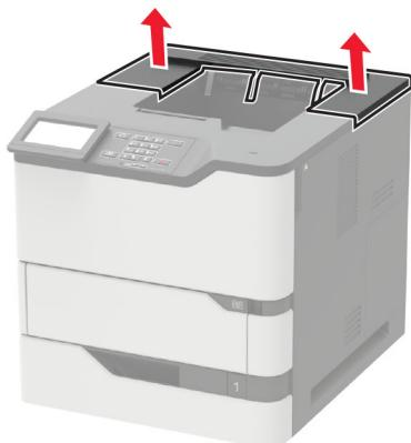
6 Instalirajte modul za proširivanje izlaznog kapaciteta na štampač.
