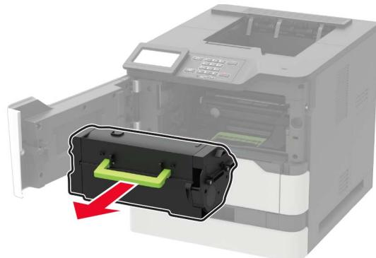
3 Uklonite jedinicu za izradu slika.
