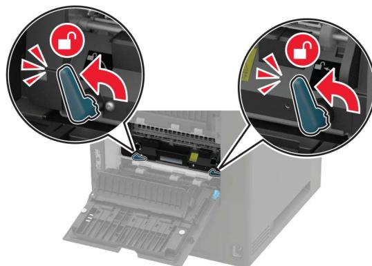
3 Uklonite iskorišćenu jedinicu za nanošenje tonera.
