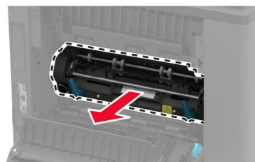
5 Otpakujte novu vruću jedinicu za nanošenje tonera sa valjkom.
