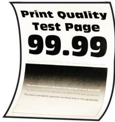
**참고:** 문제를 해결하기 전에 인쇄 품질 테스트 페이지를 인쇄해 보십시오. 제어판에서 **설정 > 문제 해결 > 인쇄 품질 테스트 페이지**로 이동합니다. 터치 스크린 프린터 모델이 아닌 경우 **OK** 을 눌러서 설정을 탐색합니다.
